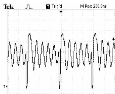
交流 110VAC，DRAIN 脚电流波形
