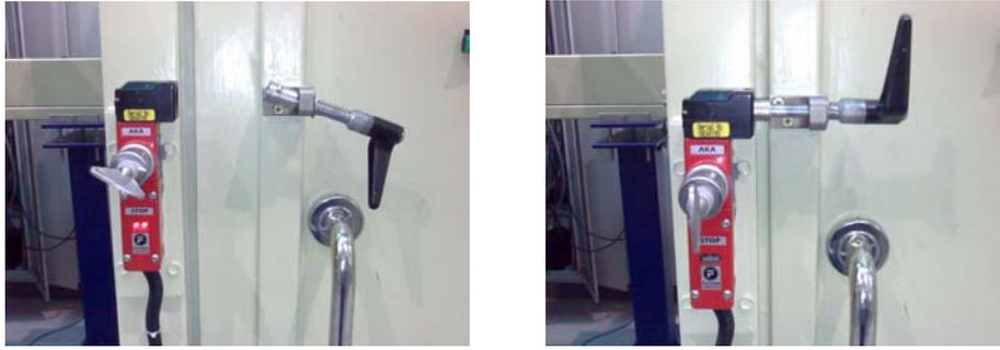
图2 棚屋外带安全连锁装置的棚屋门锁。没有锁闭状态，指示灯亮（左）；锁闭状态，指示灯灭（右）。
