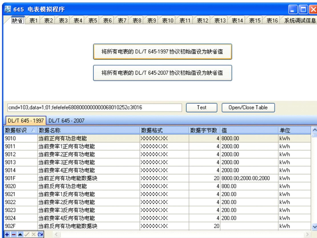
上部分显示各表位的终端与模拟电表交互的信息(即终端抄表信息),下部分为每个表位的模拟电表的数据标识的数据设置信息(参照 DL/T 645-1999),可以单独设置每个标识的值,方便电表的数据模拟测试。
