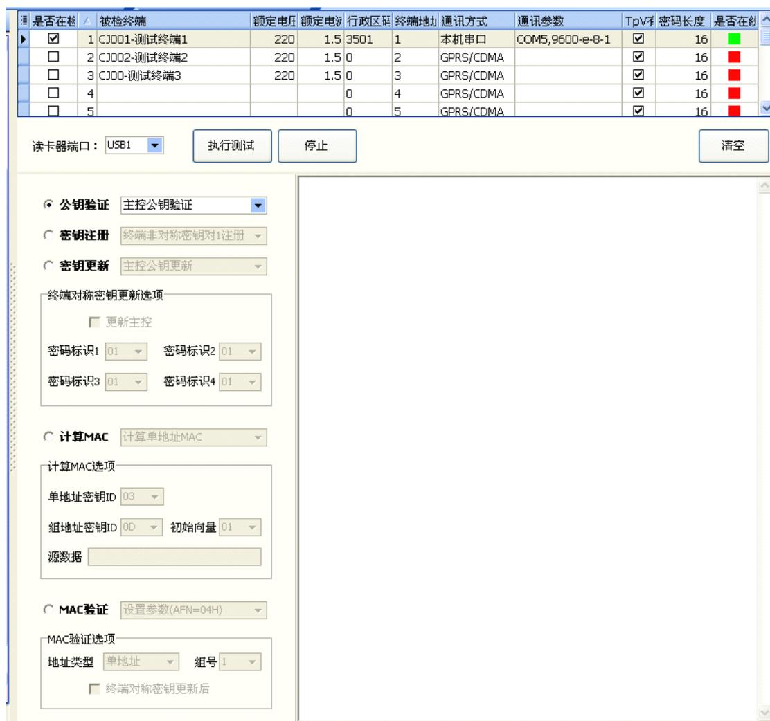
安全模块测试需要用到加密模块开发套件中的读卡器来模拟主站加密机。
