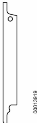
图 4 用于单可动铁芯电磁线圈的制动器开闸扳手
