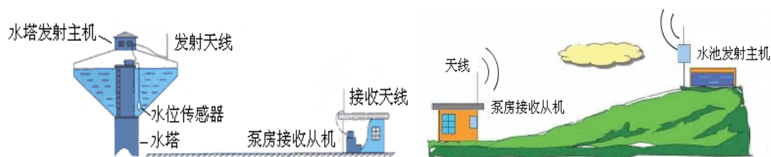
水塔水泵无线控制示意图
