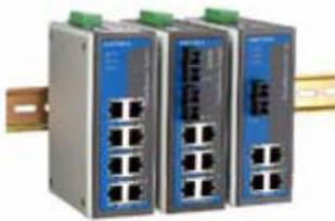
注: 在一般的系统网络应用中普通交换机也可达到同样的功能要求, 但它的可靠性远不如工业交换机, 在系统可靠性要求较高的应用现场建议使用工业级别的交换机。
