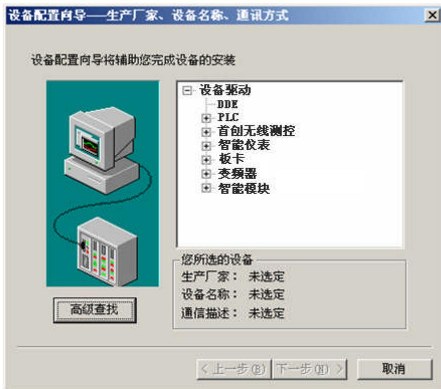
通讯方式可选择：串口通讯（RS232/422/485）、TCP/IP 以太网、采集板卡及专用通讯电缆等。这些都在驱动向导页中自动列出，不必考虑由于人为的操作失误而选择错误的通讯方式，导致系统运行时的异常。
