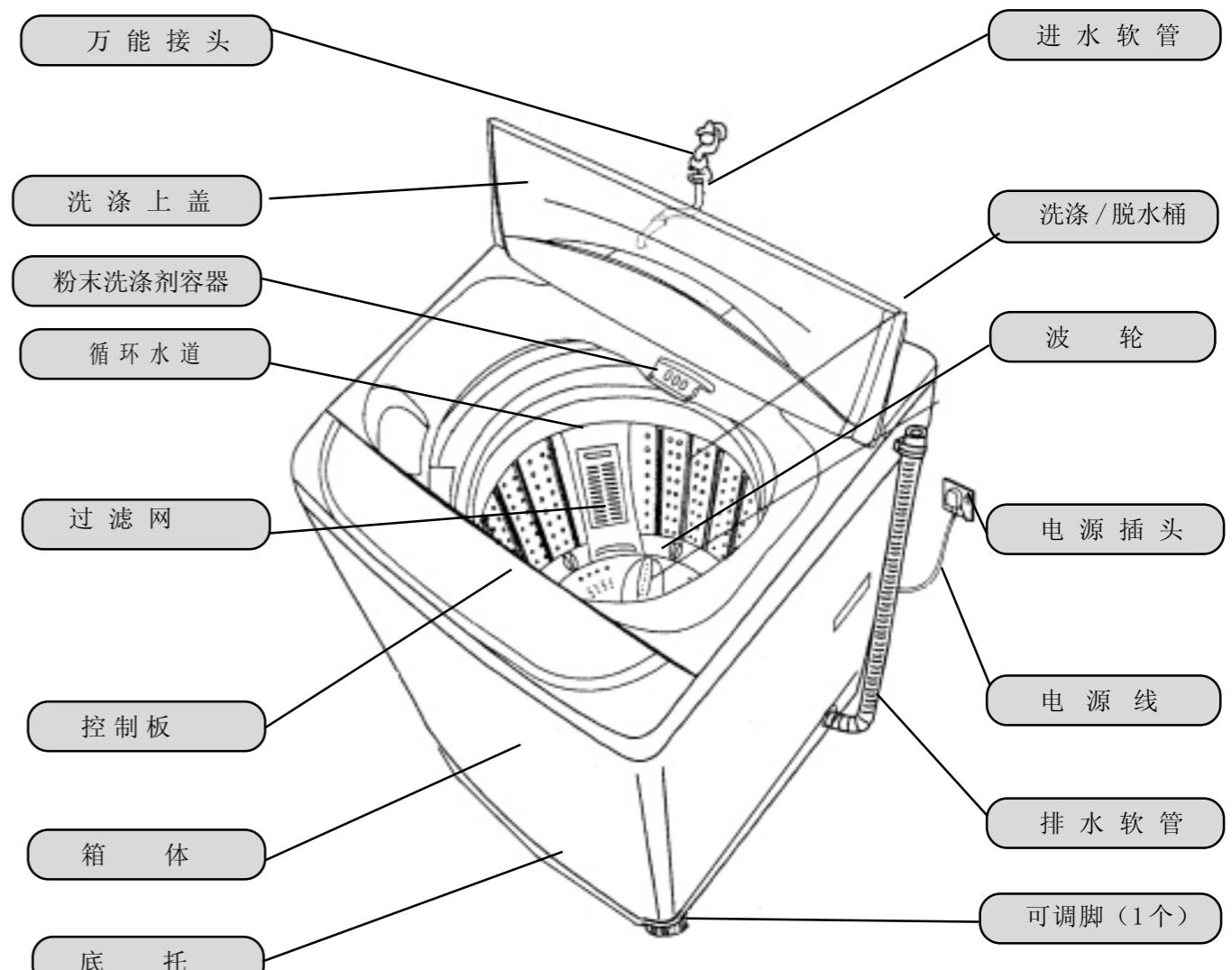
注意：1. 在洗衣机安装时，请务必拿掉洗衣机底部运输用的台座及支架，否则将无法使用。
