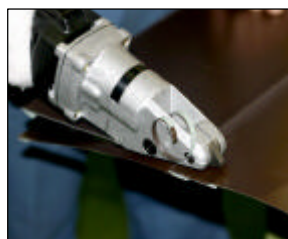
横葺成型材の切断
