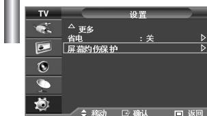
为减少屏幕灼伤的可能性，本电视机使用了屏幕灼伤保护技术。此技术可以将图像上下（垂直线）和左右（水平点）移动。
