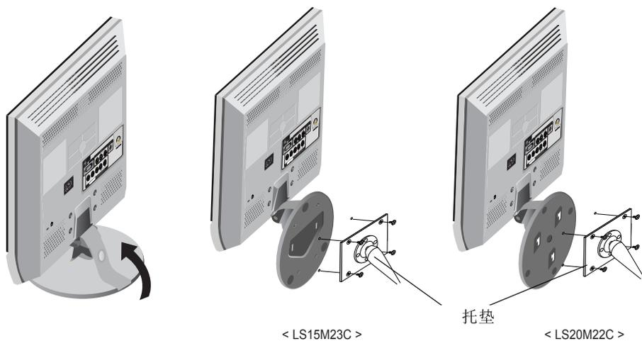
将安装接口对准后盖安装垫上的孔，用臂式基座、墙式安装吊架或其他基座携带的四颗螺丝，将安装接触垫固定住。
