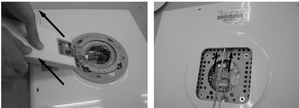
3. 提起底座，把开启驱动工具插入每一侧的槽中，压下直到发出咔嚓声。
