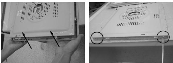
5. 拆除前盖，并从屏面拆除 4 个螺钉。
