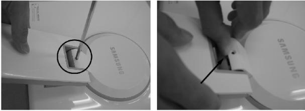
1. 将显示器面朝下放到铺有垫子的桌子上。从底座上的把手拆除 1 个螺钉，并从底座拆除后盖。
