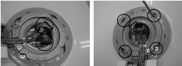
2. 断开电缆，并从底座拆除 4 个螺钉。
