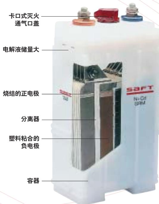
烧结式/塑料粘合电极技术使应急电源集物理强度和优异性能于一体。
