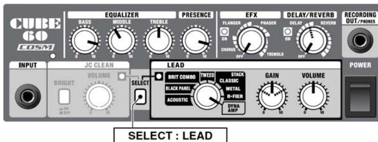
DYNA AMP 是一个原始音箱放大器，您可以使用不同的弹奏力度来改变失真。首先调节 GAIN 旋钮从而获得一个轻弹的干净音色。当您加大弹奏力度时，可以得到较重的失真。现在，可以将轻弹的和弦分解声与重弹的主音弹奏结合起来。此时，提升低频和高频创建一个宽广的声音。与 EFX、延时和混响结合使用，您可以使音色更大的表现范围。
