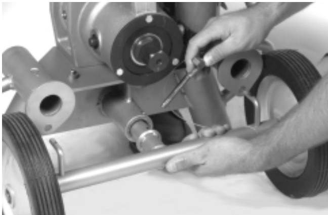
Figura 3 – Modo en que la Ranuradora se desmonta del carro para el transporte
