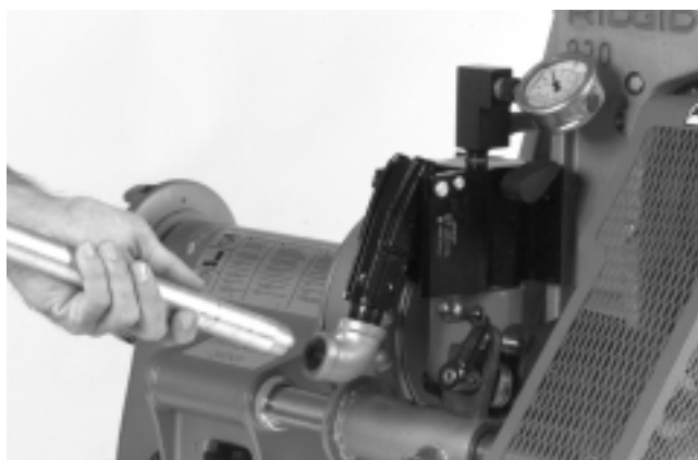
Figura 8 – Instalación de la manivela de la bomba
