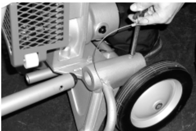
Figura 25 – Acoplamiento de las patas de soporte
