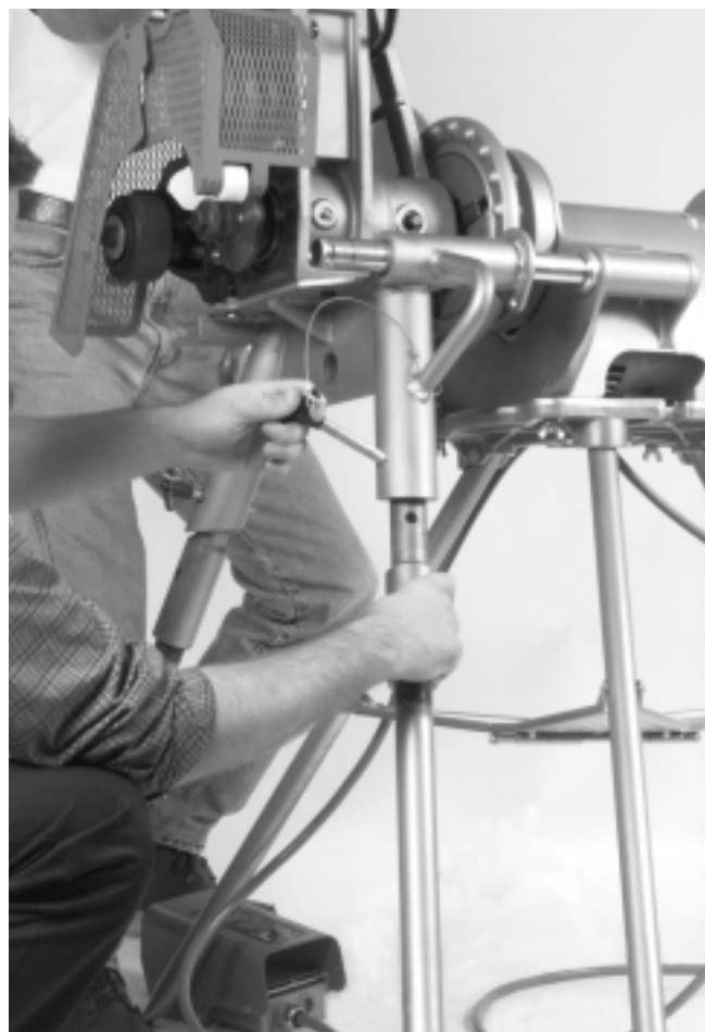
Figure 5 – Installation des pieds dans l'embase de la rainureuse
