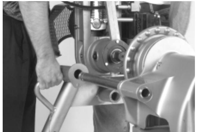
Figura 4 – Montaje de la Ranuradora a rodillos en los brazos de soporte
