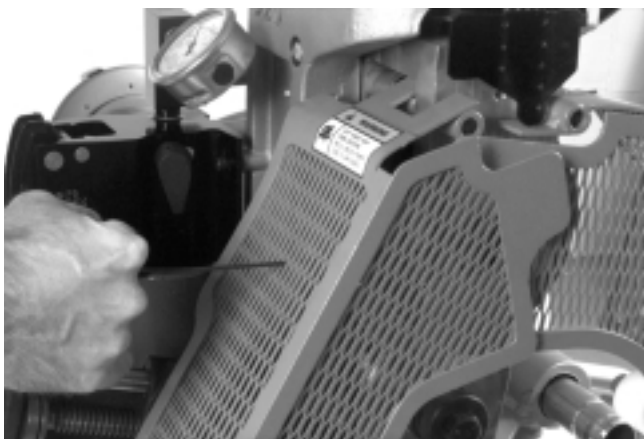
Figura 18 – Cómo aflojar el tornillo de retención en el alojamiento del rodillo superior
