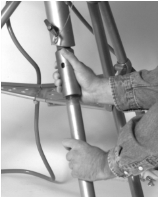
Figure 6 – Nivellement de la rainureuse par le réglage des pieds
