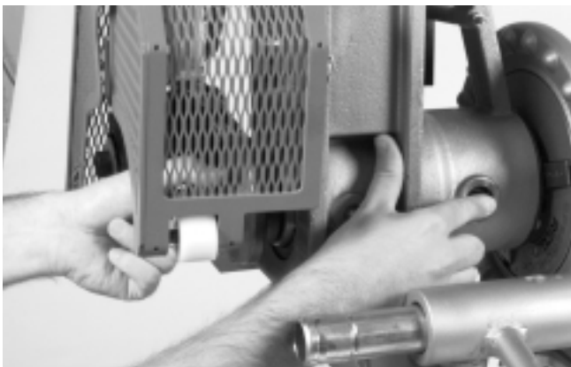
Figure 20 – Engagement de la broche d'immobilisation et retrait du galet d'entraînement
