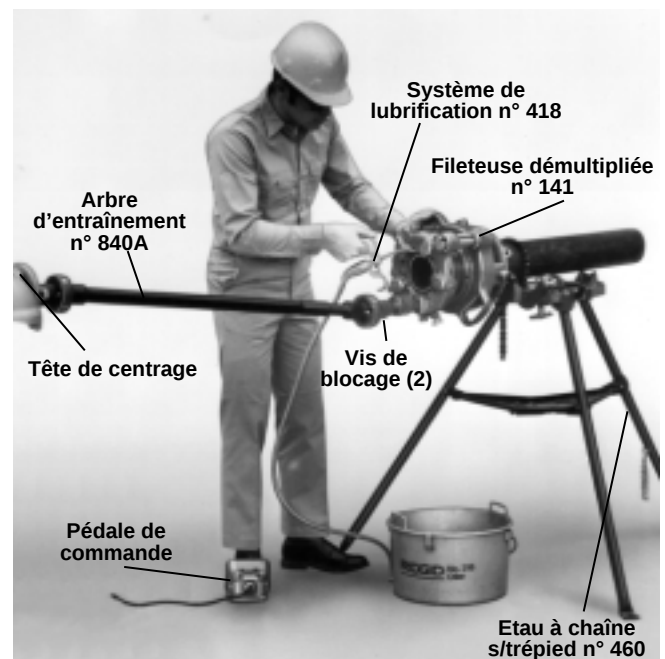
Figure 19 – Filetage des tuyaux à l'aide de l'arbre d'entraînement universel n° 840A
