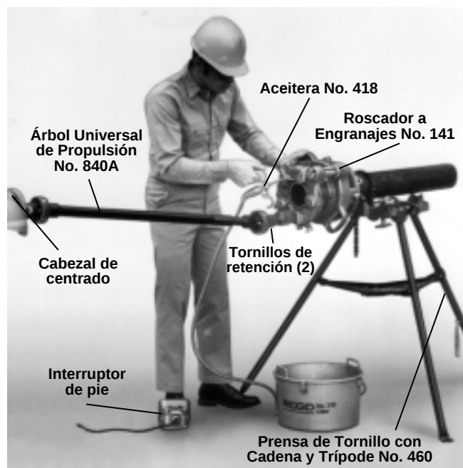
Figura 19 – Roscado de tubos usando un Árbol Universal de Propulsión No. 840A
