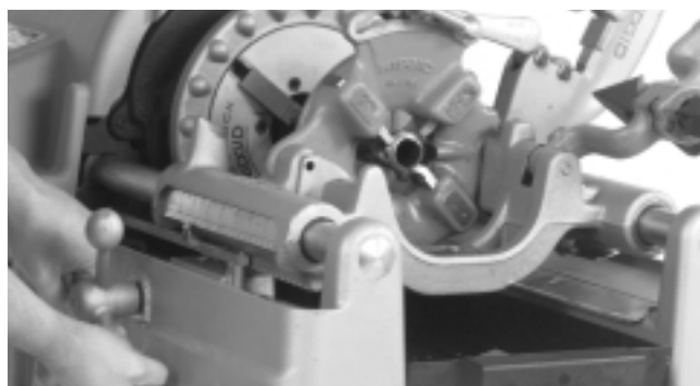
Figura 8 – Roscado con la Roscadora Manual No. 535
