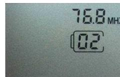
界面下，长按此键，电池框内显示 02，表示进入频率调节模式。单按 UP/SC 频率步进向上调节，长按快速向上调节。DO/MD 在短按频率向下调节，长按保存并退出频率调节模式。
