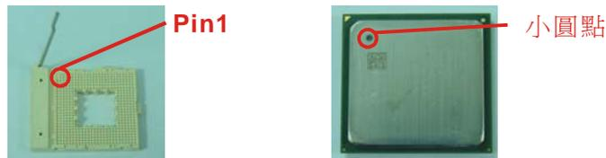
3. 將固定桿向下壓，並推到定位，這個動作會將 CPU 固定。
