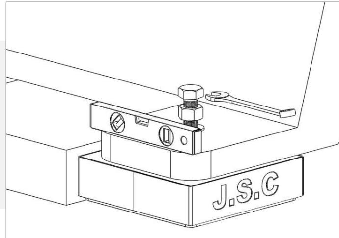
圖6)避震器高度調整完畢後將M30螺栓確實緊，即完成避震器安裝調整。
