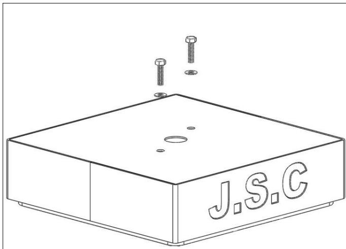
圖1)安裝前請先將兩顆M8螺栓自避震器上方移除。
