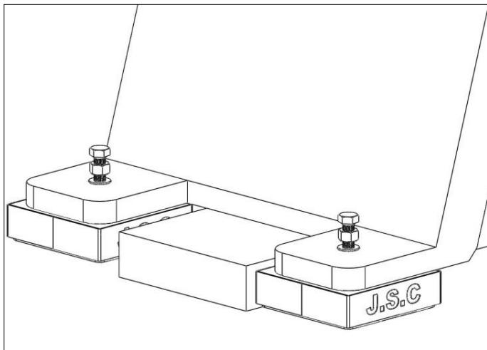
圖4)以M30螺栓將避震器與設備固定，但不鎖緊。
