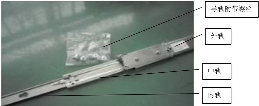
2.7.2 拨上或按下内轨卡扣将其抽出，有弹片的一端为前端，然后将内轨安装在服务器侧面。
