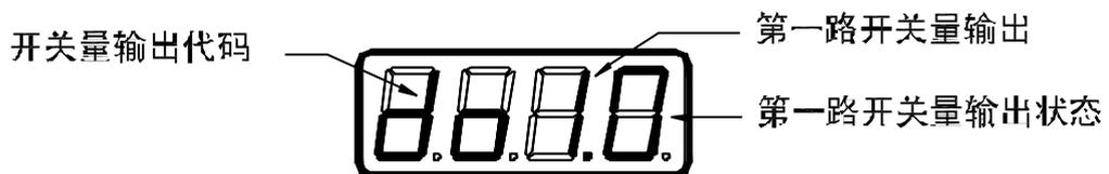
图 (b): 开关量输出示意图 (第一路开关量输出如上图，第二路开关量输出依此类推)
