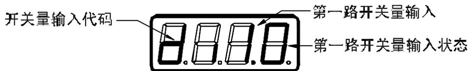
图 (a): 开关量输入示意图 (第一路开关量输入如上图，其余开关量输入依此类推)
