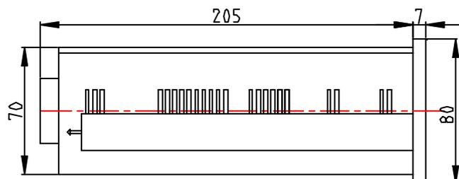
图3.1.1(a) PM9863C-1 三相交流功率因数表 侧视尺寸图
