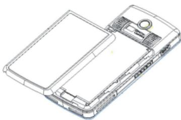
2、将 SIM 卡金属触点向下，并将 SIM 卡缺角朝上轻轻塞入卡槽缝隙，向下推 SIM 卡，直到不能推动为止，如下图：
