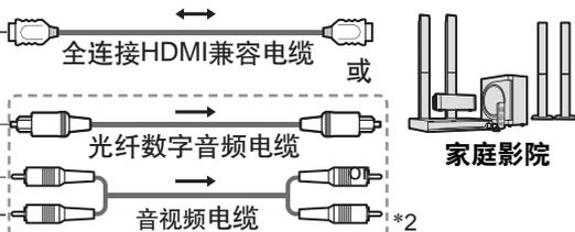
\*2: 如果外部连接设备具有“HDMI Control 5”功能, 可以不必使用音频电缆(光纤数字音频电缆或音视频电缆)。这种情况下, 用HDMI电缆连接设备到电视机的HDMI2端子。
