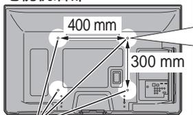
壁挂式支架安装孔
