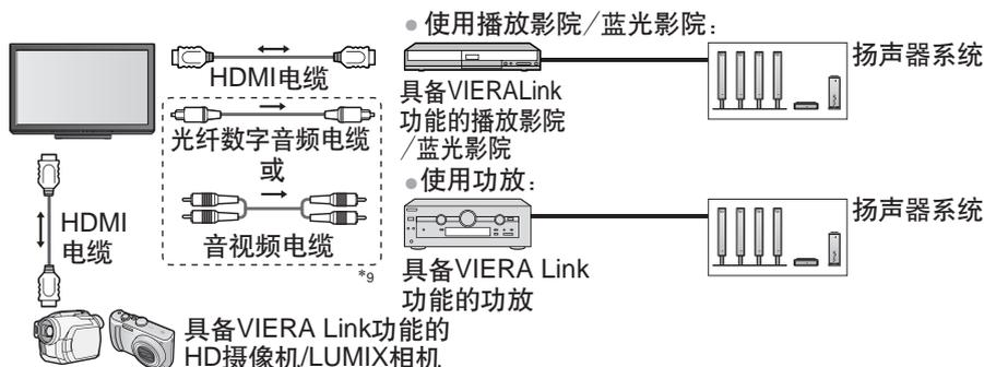
\*9: 如果外部连接设备具有“HDAVI Control 5”功能，可以不必使用音视频电缆(光纤数字音频电缆或音视频电缆)。这种情况下，用HDMI电缆连接设备到电视机的HDMI2端子。
