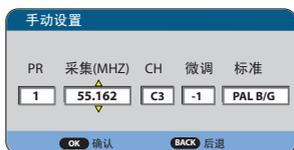
{ 手动设置 } - 按 **OK** 进入手动设置菜单。使用 **▲▼** 键更改设置，使用 **◀▶** 键移至上一/下一输入字段。
