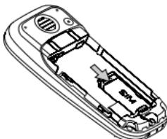
5. 将电池插入槽中(确定其电池连接器朝上手机连接器)并将按下直卡定到位。
