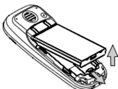
4. 将SIM卡滑入卡槽(确定其缺角对准正确位置并且连接器正向手机)
