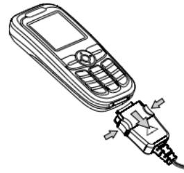
**电池完全充电后，继续将连接器连接在手机上不会损害电池。**
