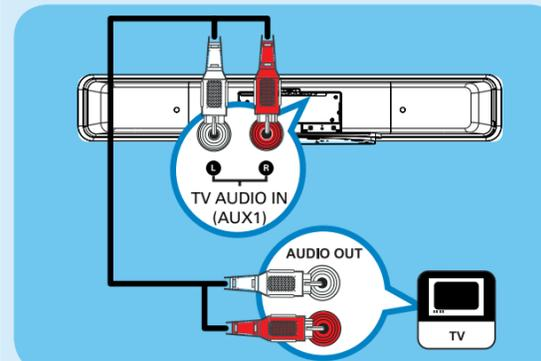
**注** 要通过此连接收听音频输出，请反复按 AUX/DI /MP3 LINK，直到显示面板上显示“AUX1 INPUT”。
