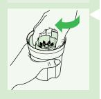
3 將攪拌刀座旋緊在研磨杯上。 在濕墊圈上沾一些水可幫助您施力。
