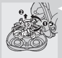
**1** 打开剃须刀头部件，逆时针转动锁(1)，取下固定架(2)。
