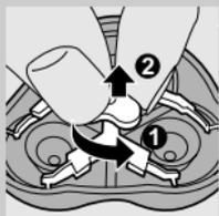
**1** 打开剃须刀头部件，逆时针方向转动轮轴 (1) 并取下固定架 (2)。
