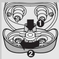
**5** 把固定架放回電鬚刀組上，將轉盤向下壓 (1) 並以順時針方向轉動 (2)。
