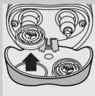
**4** 取出電鬚刀刀頭，然後在電鬚刀組裝上新的刀頭。
