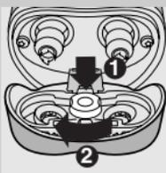
**5** Kembalikan rangka penahan ke dalam unit pencukur, tekan roda (1) dan putarkan ke arah jam (2).
