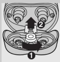
**1** 打開電鬚刀組，以逆時針方向轉動轉盤 (1)，拆下固定架 (2)。
