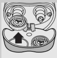
**4** 取下剃须刀头，在剃须刀头部件上装上新的剃刀须头。
