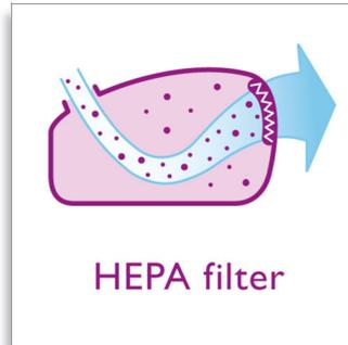
這種 HEPA 隔濾網可過濾各種會引致呼吸性過敏的有害微生物。為保持卓越的過濾效果，應每 6 個月更換一次 HEPA 隔濾網。
