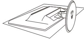
2. 按锁定夹，从底座支撑柱上卸下底座支撑臂。
