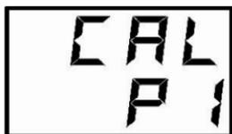
5、按  $\approx$  或  $\cong$  键将副显示屏幕显示(图一)表示标定记忆中,(图二)表示完成标定记忆。随即显示标准液数值,等待第二组标准液校正。
