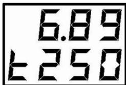
4、按 M 键 3 秒钟进入功能菜单，按 M 键找到主显示屏显示 CAL 如下图，表示机器等待第一组（6.85、9.18、4.01）标准液校正。
