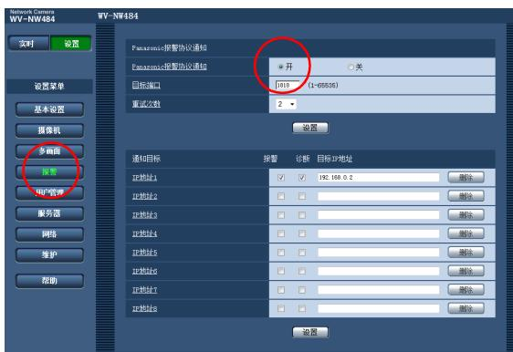
仅当网络硬盘录像机等 Panasonic 设备连接在系统中的时候才能使用此功能。如果将“Panasonic 报警协议”选择为“开”，则通知所连接的 Panasonic 设备摄像机处于报警状态。“Panasonic 报警协议”的设置可以在“报警”页面的 [通知] 标签页中的“Panasonic 报警协议通知”选项进行。（[使用说明书 设置篇](#)）
