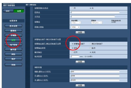
报警发生时，可以从摄像机后面的报警插口输出信号，并且使蜂鸣器鸣叫。报警输出的设置可以在“报警”页面中的[报警]标签页的“报警输出端子”选项进行。
