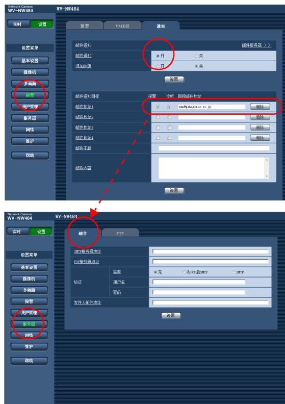
可以在发生报警时将报警邮件（报警发生通知）发送到事先注册的电子邮件地址，最多4个地址可以注册为报警邮件的接收者，报警图像（静态图像）可以作为报警邮件的附件发送。报警邮件的设置可以在“报警”页面的[通知]标签页中的“邮件通知”部分（[使用说明书设置篇](#)）和“服务器”页面的[邮件]标签页中（[使用说明书设置篇](#)）进行。
