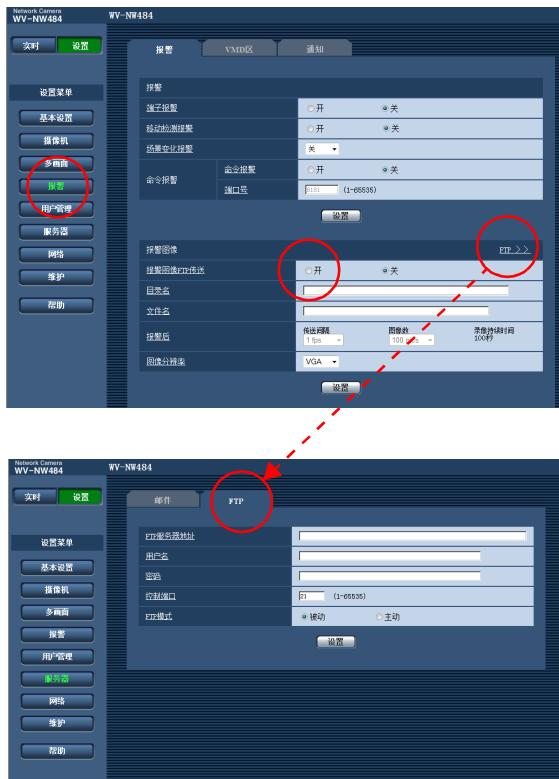
可以在报警发生的时候向事先指定的服务器传送报警图像。向服务器传送报警图像所需的设置可以在“报警”页面的[报警]标签页中的“报警图像”选项（[使用说明书设置篇](#)）和“服务器”页面的[FTP]标签页中（[使用说明书设置篇](#)）进行。
