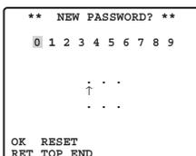
**Nota:** Il menu NEW PASSWORD è accessibile soltanto dopo aver completato la verifica. Appare il segno freccia in alto che indica la prima cifra sulla prima riga.
