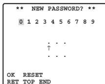
**Nota:** El menú NEW PASSWORD sólo es accesible después de haberse completado la verificación. Aparece el signo de la flecha de movimiento hacia arriba indicando el primer dígito de la primera línea.
