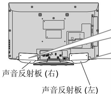
为了更好的声音效果安装声音反射板
