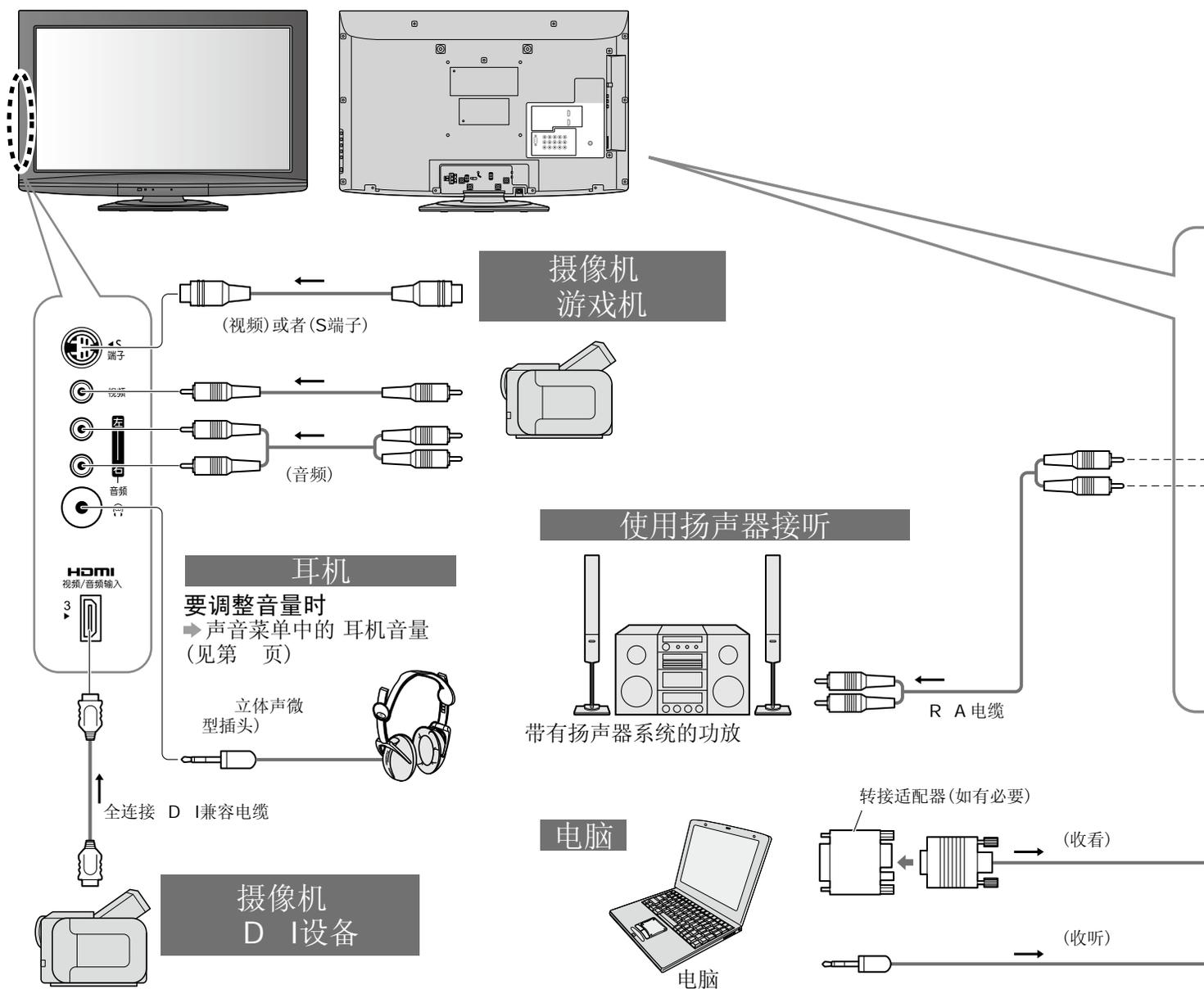
连接至每一端子的可连接设备类型
