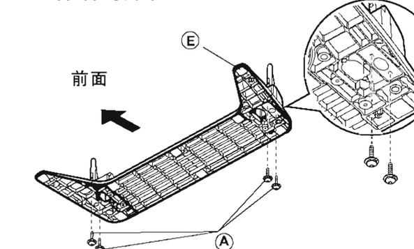
用组装螺钉Ⓐ，将杆紧紧地固定在基座的底部。
