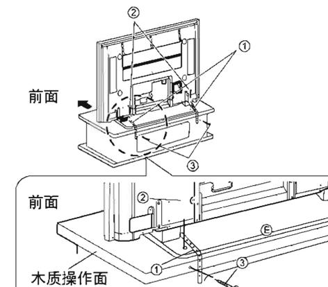
用木螺钉固定到木质操作面后缘上的孔中，如果没有孔，那么要在木质工作厚度方面的正中间先钻孔，然后再用木螺钉来固定压条。
