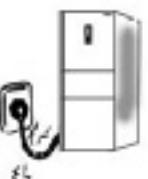
(请勿损坏电源线或对其进行加工; 请勿过度弯曲、拉伸、扭转、捆扎、重物重压; 请勿将其靠近发热器具。)
