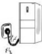
(请勿损坏电源线或对其进行加工; 请勿过度弯曲、拉伸、扭转、捆扎、重物重压; 请勿将其靠近发热器具。)
