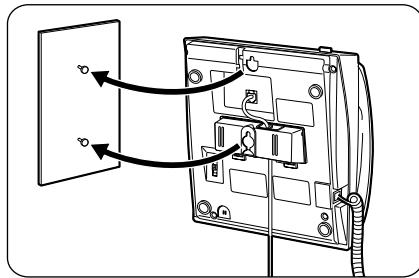
2 连接电话线，将附座（包括）插入中央槽内。（应确保电话线穿过附座的开口以防止损坏连接器）。
