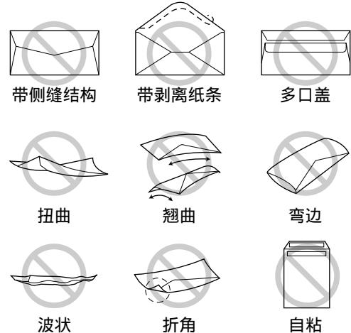
请勿试图在下列类型的信封上打印 ( 会引起传真机损坏 )：
