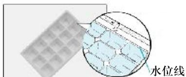
取出制冰盒，将水放至水位线，并将制冰盒放到原位，进行制冰。
