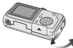
2 将电池 ⊕ 和 ⊖ 两极正确对好插入电池。
