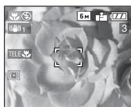
当转动变焦杆最接近远摄时，可以接近物体拍照，物体距镜头的距离最多  $1\text{ m}$ 。（出现远摄微距图标 [**TELE**]。）当站着拍摄接近地面盛开花朵的特写图片或从远处拍摄昆虫的特写图片时，本功能会很方便。
