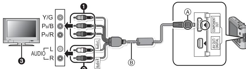
**①** 色差分量插头：将插头连接到电视机上相同颜色的色差分量视频输入接口上。（电视机上的指示可能会不同。）
