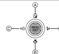
操纵杆是以两种不同的方法进行操作：可以向上、下、左、右倾斜操纵杆执行操作，或者可以按下操纵杆进行选定。在本使用说明书中，操纵杆是像下图所显示的那样或是用 ▲/▼/◀/▶ 进行说明的。
