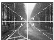
(A) [■■■]: 当将整个屏幕分割成  $3 \times 3$  以便拍摄构图均匀的图片时，请使用此项。
