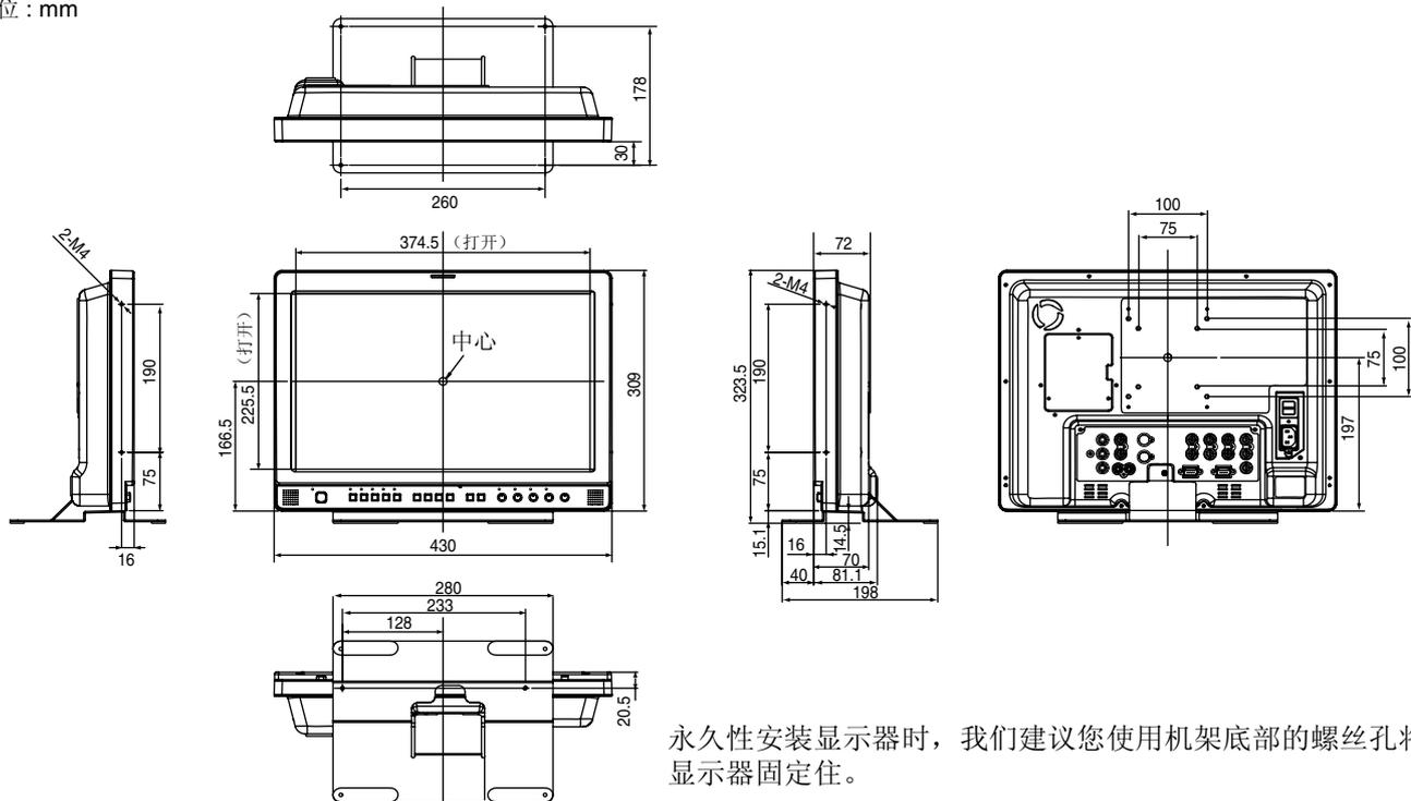
永久性安装显示器时，我们建议您使用机架底部的螺丝孔将显示器固定住。
