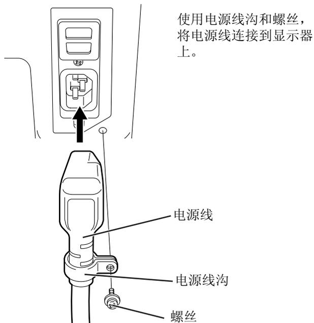
2. 将电源线连接到电源插座。
