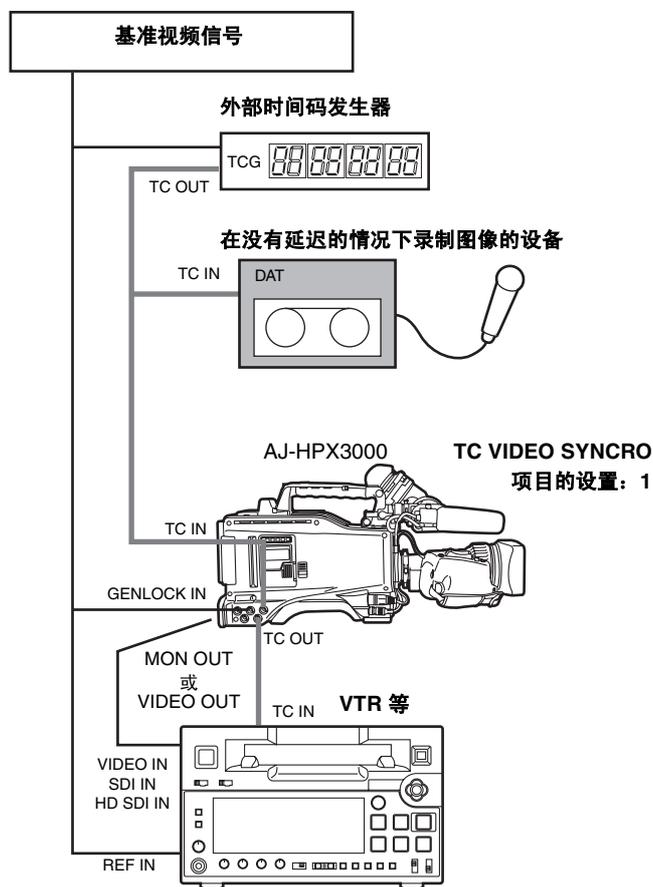
**示例4:** 当本机和外部设备锁定到外部连接的外部时间码发生器时，并且当摄像机的几个单元串联连接时。
