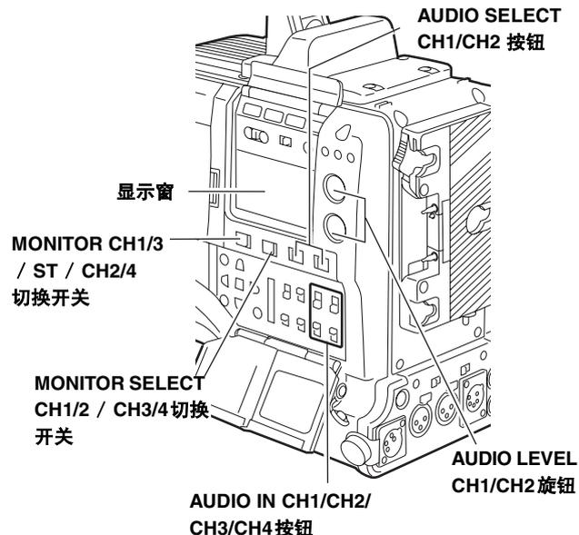
在SD模式（带有480i或576i的DVCPRO50、DVCPRO或DV）下，出厂状态设置的是声道3/4不记录。想要进行4声道记录，请将25M REC CH SEL项设置为“4CH”。
