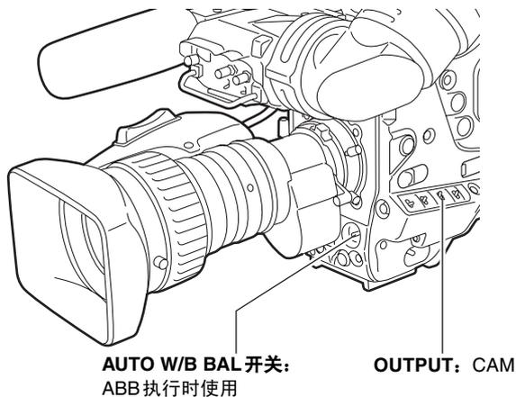
2 将 AUTO W/B BAL 开关拨至“ABB”侧，松开开关。开关回到中央，执行调整。
