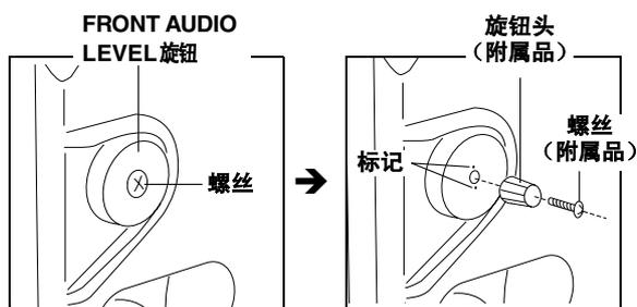
旋出 FRONT AUDIO LEVEL 旋钮中央的螺丝，将本机附带的旋钮头用同样是附属品的螺丝紧固。这时请将旋钮的标记和旋钮头的标记对准。
