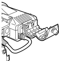
**2** 安装话筒，拧紧固定螺丝。话筒在安装时必须使话筒上的UP标志朝上。
