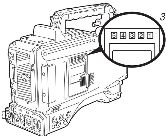
而且关闭电源后仍保持记录对象的P2卡号码，再次打开电源时能在电源关闭前的同一张P2卡上继续记录。
