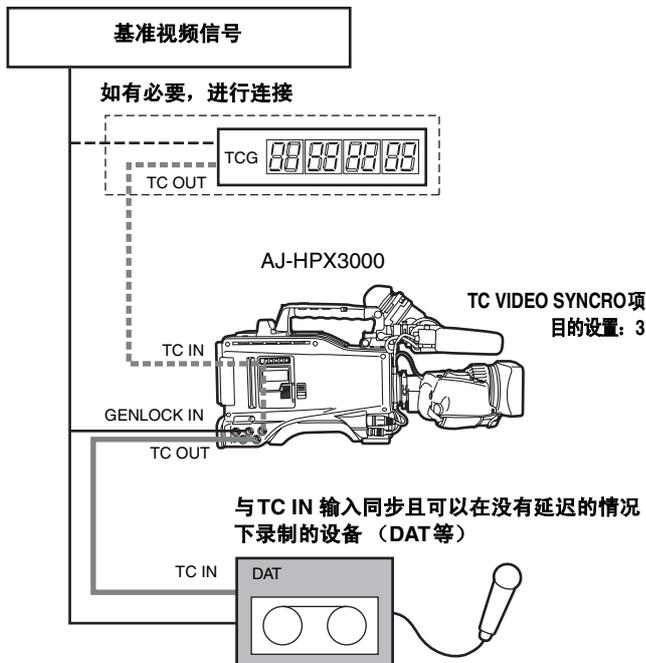
示例6: 当外部设备锁定到串联的本机的时间码发生器时。
