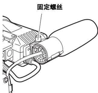
**3** 将话筒的接线连接到话筒的MIC IN端子。
