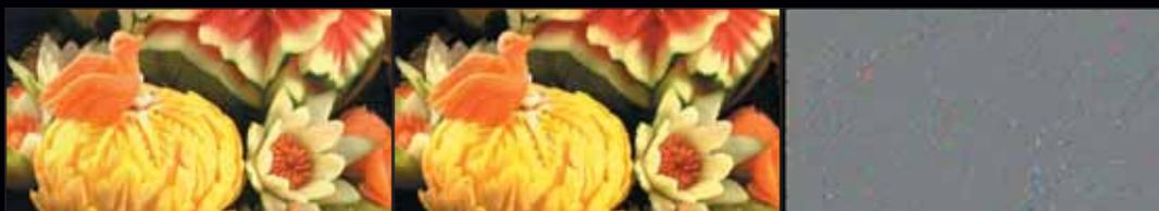
(左)原图像(中)帧内预测图像(右)从原图像中减去帧内预测图像的差值图像。可以看出帧内编辑的高精度。
