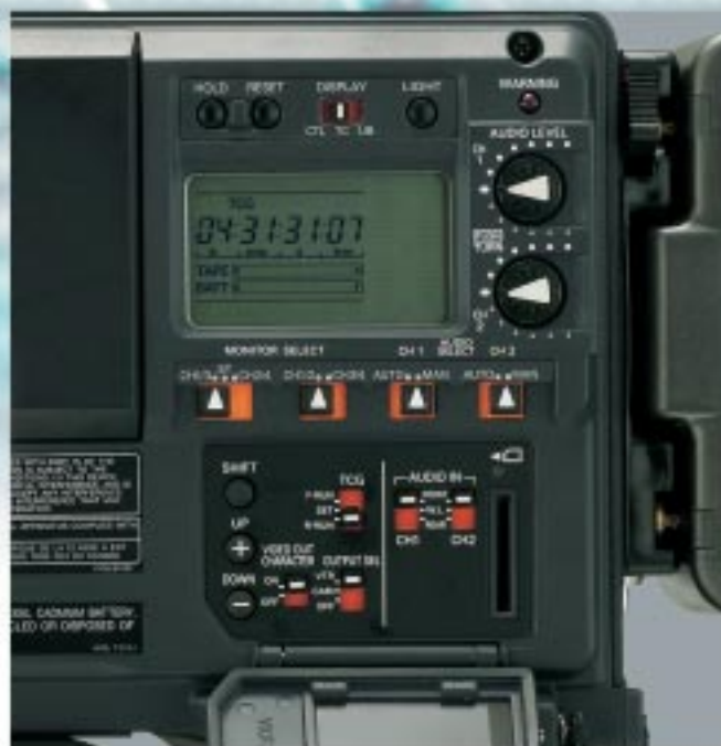
侧面操作区和 LCD 显示板
